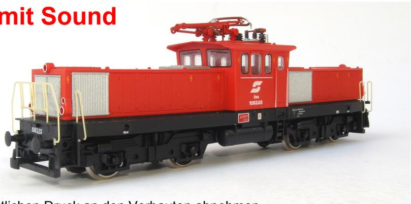
Das Gehäuse lässt sich mit leichtem seitlichen Druck an den Vorbauten abnehmen.
