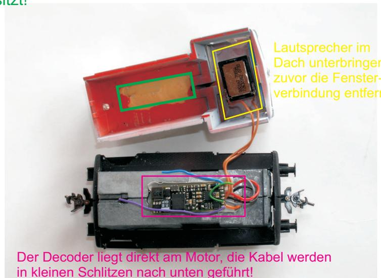
Die Decoderkabel wurden entsprechend gekürzt und links und rechts neben der Motorwelle nach unten geführt, ein kleiner Schlitz (gefeilt) erleichtert die Verlegung.
